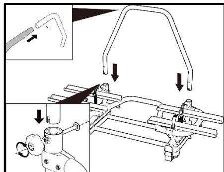
Bevestig deze U-beugel met de bijgeleverde slotbouten (M8x60), sluitringen en kunststof draaiknoppen. Zorg dat de draaiknop aan de voorkant zit.
