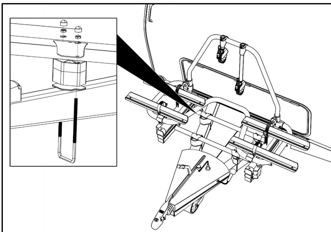
Om er voor te zorgen dat de drager op zijn plaats blijft dient deze geborgd te worden met de vier schroefjes.
