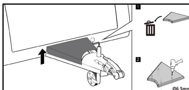
Verwenden Sie bei Bedarf die Distanzklötze, um die Wölbung der Abdeckhaube der Deichsel auszugleichen. 1 Block um 15 mm zu erhöhen und bis auf Maximum 60 mm zu erhöhen.
