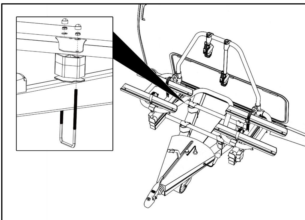
Um dafür zu sorgen, dass der Träger auf seinem Platz bleibt wird dieser fixiert, indem Sie die vier Bohrungen der Gegenbleche in das Basisrohr übertragen. Bohren Sie diese Löcher 4 mm groß. Danach wird mit den mitgelieferten Schrauben der Träger fixiert.
