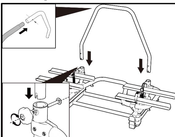
Befestigen Sie den U-Bügel mit den mitgelieferten Schloss - Schrauben (M8x60), Scheiben und den Kunststoff Rändelmuttern. Die Kunststoff Rändelmuttern müssen an der Vorderseite montiert sein.
